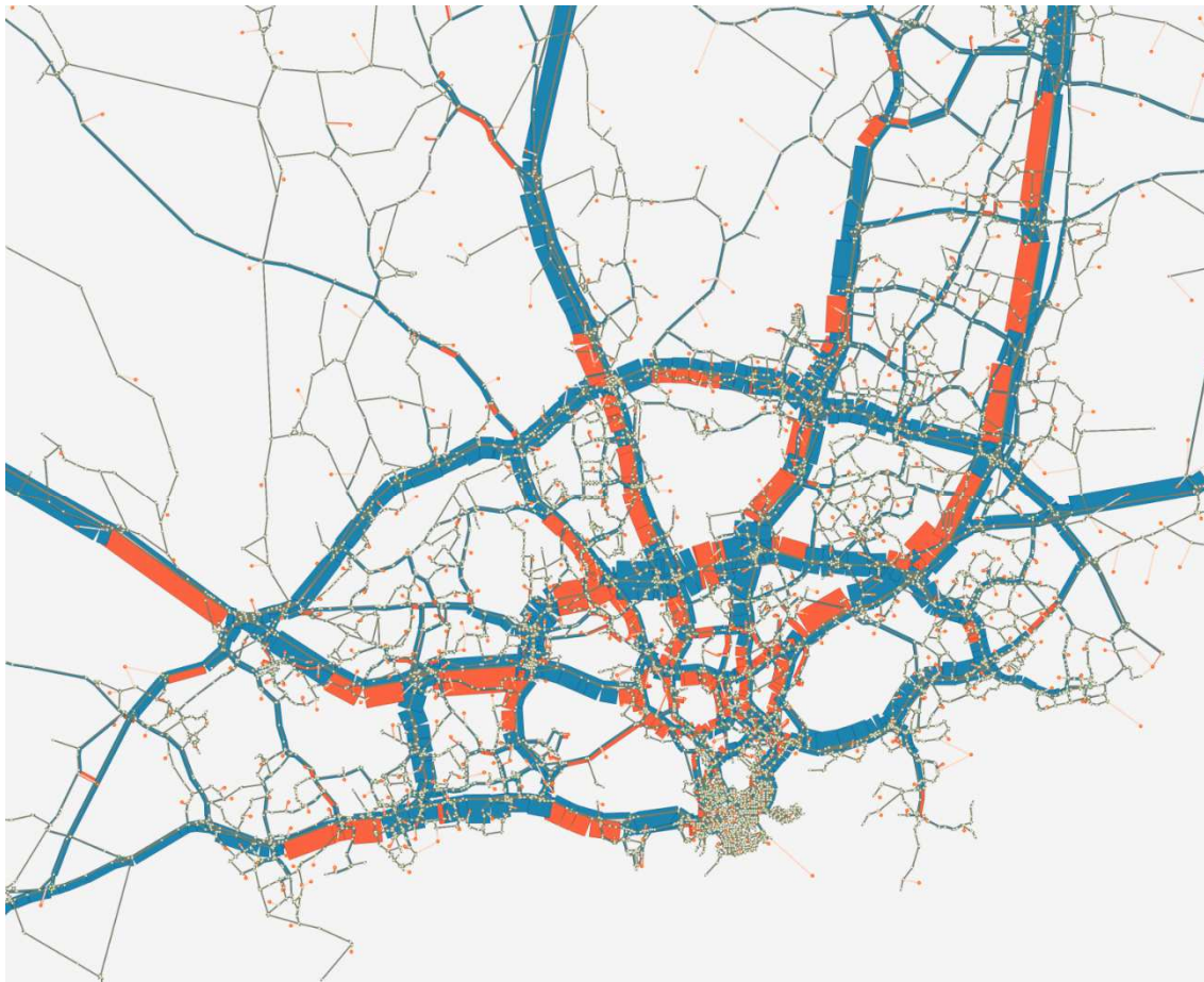
Kuva 1. Punaisella linkit, joilla leikkuri on käytössä nykytilanteen liikennemäärillä ja -verkolla.
