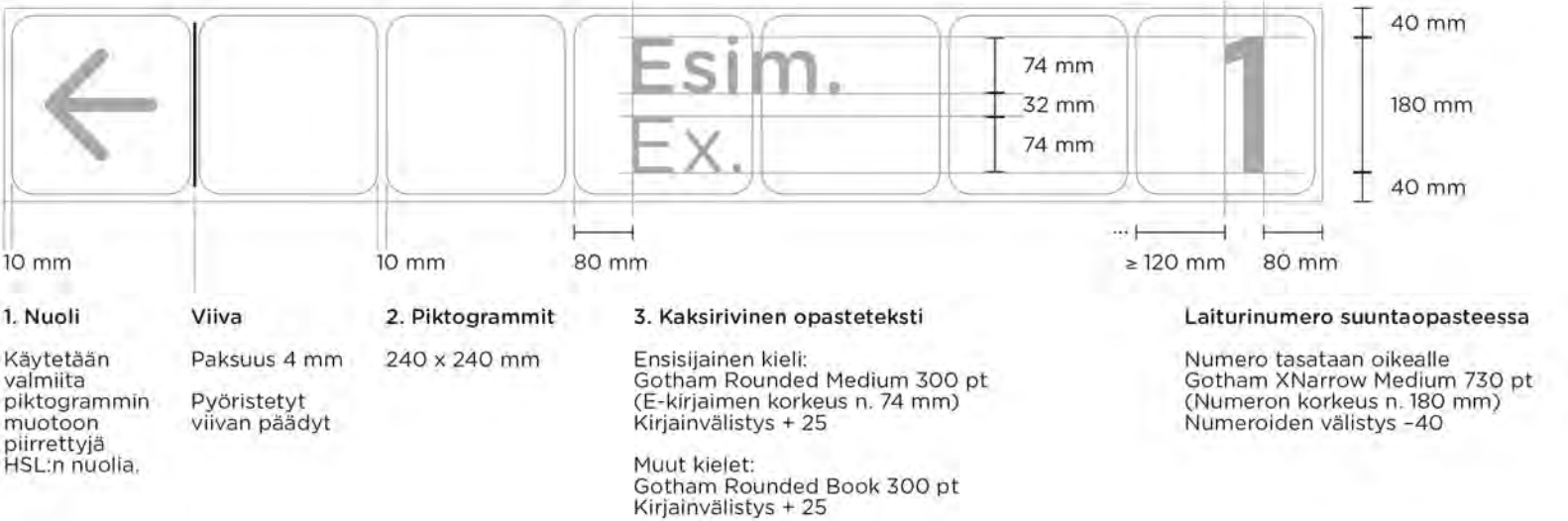
Kuva 24. Normaalin suuntaopasteen mitoitus.
