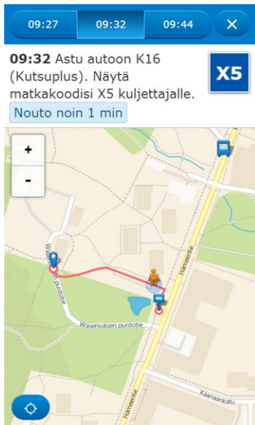
Kuva 6b – Tosiainen matkustajainformaatio GPS- paikannusjärjestelmällä varustetulla älypuhelimella, © HSL ja Split Finland Oy
