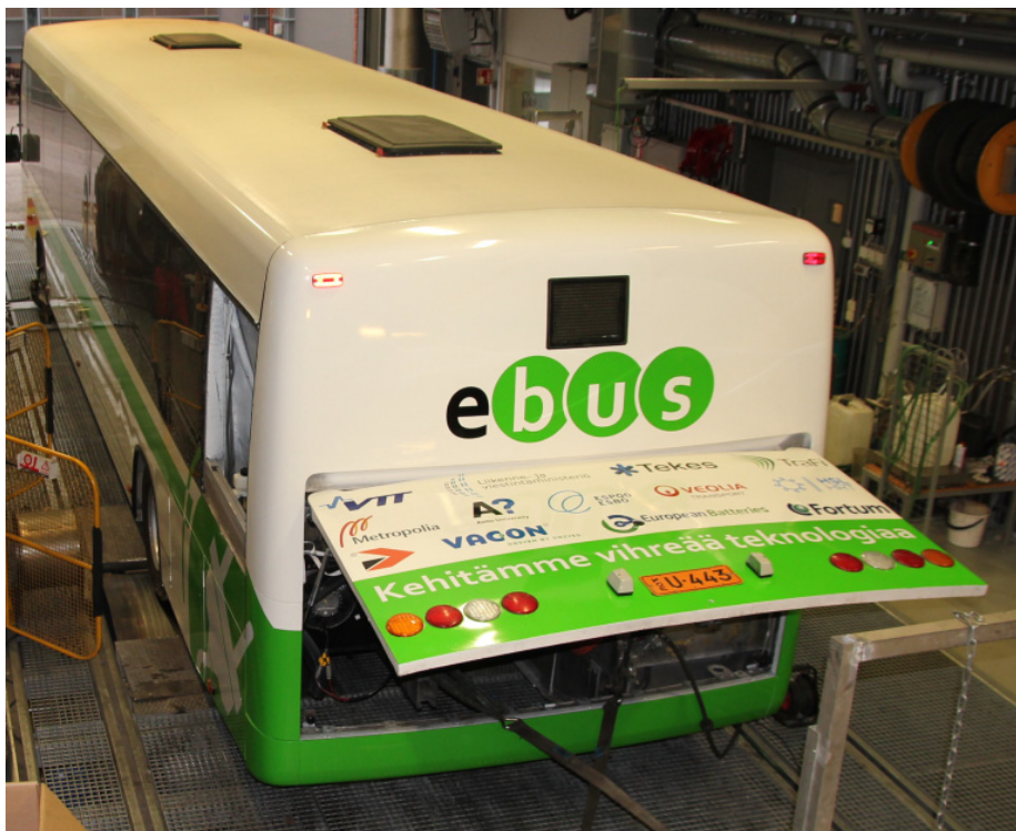
Kuva 47. eBus "testimuuli", eli kevytrakenteisen Kabus kaupunkilinja-auton pohjalle rakennettu sähköbussi. Kuva VTT.
