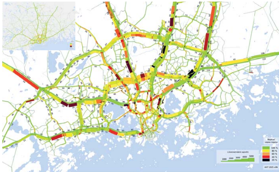
Kuva 3. Pullonkauloja Helsingin seudulla aamuruuhkassa vuonna 2025 HLJ 2015 vertailuvaihtoehdossa (VE0). Yhteysväliet, joilla nopeus on alle 60 % suhteessa vapaisiin olosuhteisiin. Kuvassa värit kuvaavat tieosuuksia seuraavasti: oranssi = ruuhkautuvat, punainen = ruuhkaiset, musta = voimakkaasti ruuhkautuvat yhteysväliet
