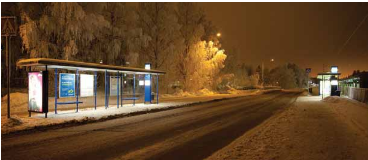
Kuva 6.4-9 Hyvin valaistut pysäkit erottuvat tehokkaasti. Pysäkkien ympäristön valaistukseen tulee kiinnittää huomiota, etteivät esimerkiksi pysäkkien kohdalla olevat suojatiet jää liian pimeiksi.
