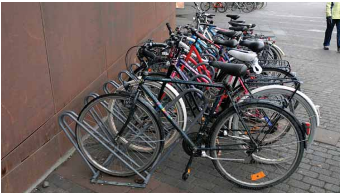
Kuva 6.3-3 Pitkäaikaiseen pyöräpysäköintiin soveltuva runkolukittava rengastelinemalli (Tubular, Omni Sheltec).
