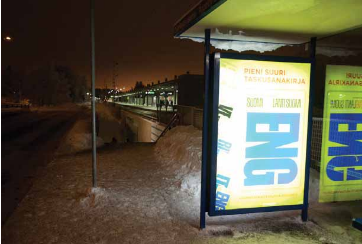
Kuva 6.4-10 Huonosti valaistu reitti pysäkin ja asemalaiturin välillä vaikuttaa entistä pimeämmältä hyvän pysäkkivalaistuksen jälkeen.
