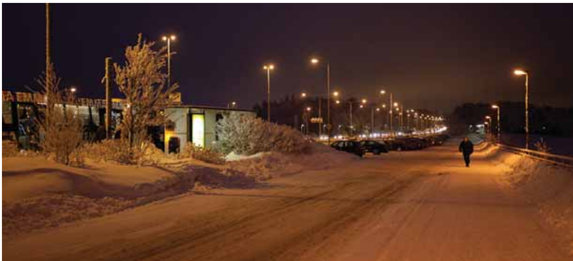
Kuva 6.4-4 Kevyenliikenteenväylän puolelle sijoitettu matala valaisinrivi korostaa hyvin jalan-kulkureitin.
