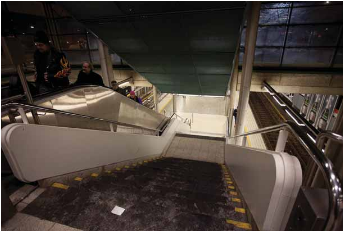
Kuva 6.4-12 Metalliverkko syö huomattavasti sen taakse asennettujen valaisimien valotehoa ja tummat materiaalivalinnat korostavat pimeyden tunnetta entisestään.
