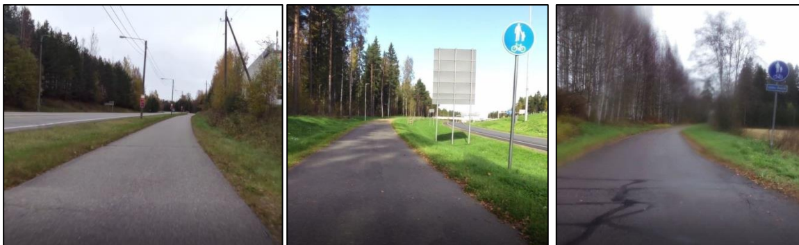
Kuva 16. Erottelu ei ole lähtökohtaisesti tarpeen maantieympäristöissä ja omassa linjauksessaan kulkevilla pyöräiteillä, joilla hyvin vähäistä (<15 jalankulkijaa tunnissa) jalankulkua
