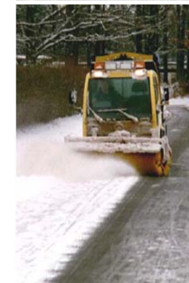
Kuva 5. Wille ja nivelaurea (verkkoterä). Lumi voidaan aurata vasemmalle tai oikealle, lisäksi lunta voidaan kuljettaa lyhyitä matkoja puskemalla.
