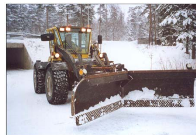
Kuva 5. Wille ja nivelaurea (verkkoterä). Lumi voidaan aurata vasemmalle tai oikealle, lisäksi lunta voidaan kuljettaa lyhyitä matkoja puskemalla.
