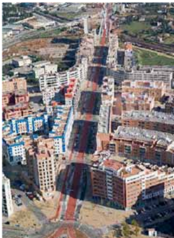
Kuva 35. Castellón linja 1 ( www.bhls.eu ). Joukkoliikennekaista on pinnoitettu punaisella värillä.
