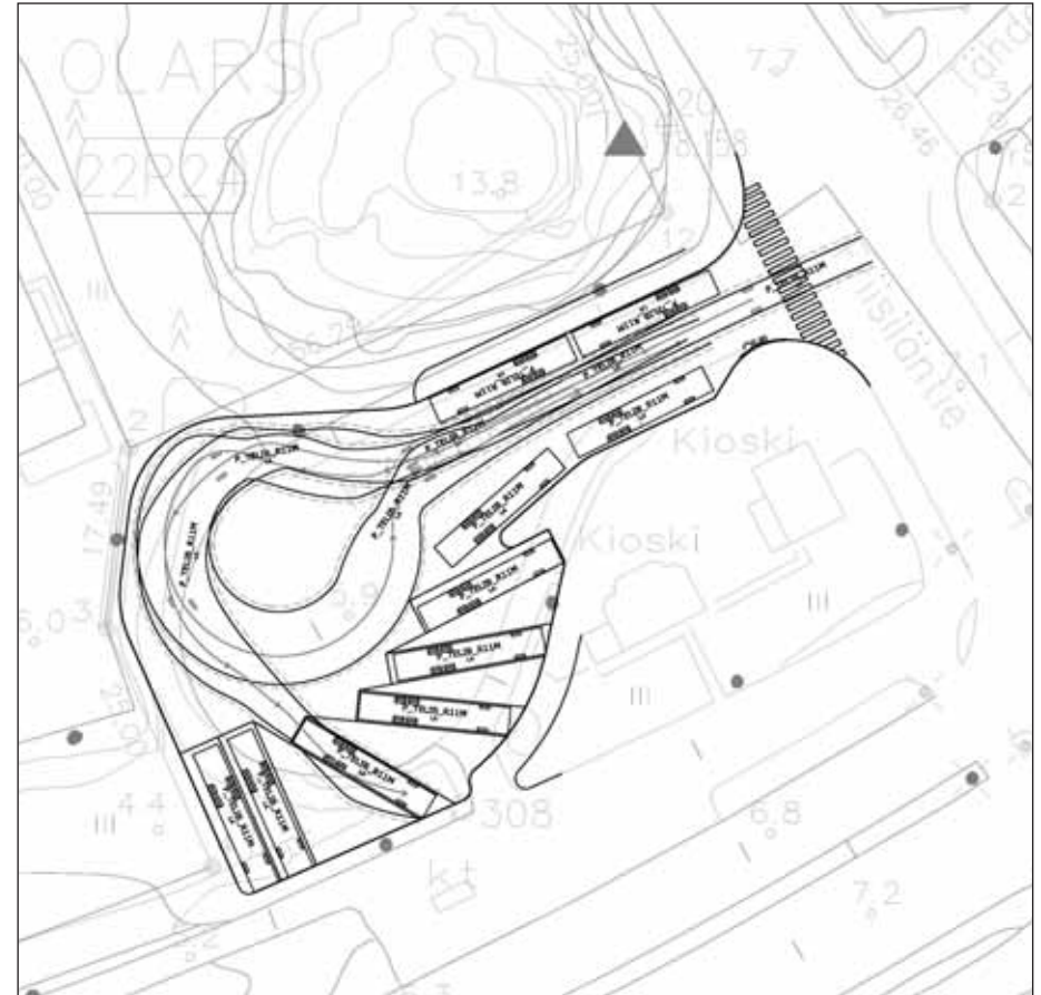
Kuva 65. Friisilän kääntöpaikan laajennussuunnitelma: järjestelyt ja telibussin ajouratarkastelut
